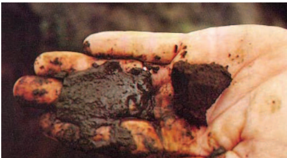
Mynd 12.13. Mold og flæðimark. Klumpurinn til hægri er óraskað jarðvegssýni, en til vinstri er annar klumpur sem hefur verið velt um í lófanum. Vatnsinnihaldið var það hátt að moldarsýnið náði skyndilega flæðimarkinu. Þessi jarðvegur er úr Mýrdal.
