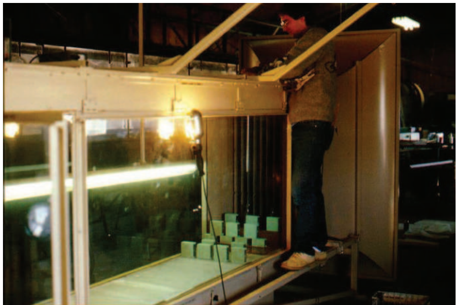
Mynd 18.16. Vindgöng í Big Spring í Texas sem notuð voru til að þróa áfram vindrofsjöfnuna. Þarna er verið að undirbúa tilraun með íslenska mold en niðurstöðurnar sýndu einstæða rofgirni íslenskra jarðvegsefna og gjósku.
