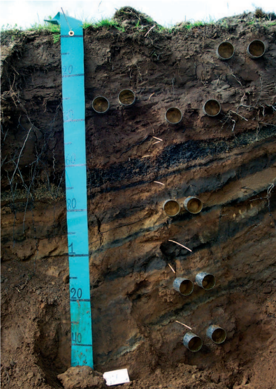
Mynd 12.3. Mælingar á rúmþyngd jarðvegslaga í sniði nálægt Gullfossi. Dósir (frá Ora í þessu tilfelli) sem eru opnar í báða enda eru reknar varlega inn í tiltekið jarðvegslag. Síðan er skorið frá dósunum og þær teknar, moldin þurrkuð og vegin til að ákvarða rúmþyngd. Að lokum er jarðvegurinn sigtaður til að kanna hvort korn >2 mm séu til staðar en þau þarf að draga frá (vigt og rúmmál). Þetta snið einkennist af mörgum grófum gjóskulögum úr Heklu og Kötlum. Myndin tengist BSc-verkefni Rannveigar Guicharnaud (2002), en hún rannsakaði rúmþyngd moldar vítt og breitt um landið.
